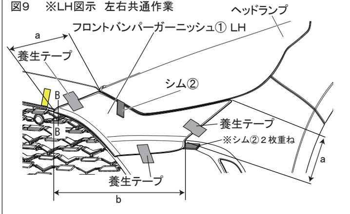
2. 図9のようにシム②をフロントバンパーガーニッシュ①とヘッドランプとの隙間に差し込み、シム②を二枚重ね図中の位置でフロントバンパーガーニッシュ①とフロントバンパーとの隙間に入れて取付け位置を一定隙 (a: 1mm、b: 2mm) にし、クッション部を突き当てながら、養生テープ等で仮固定する。
