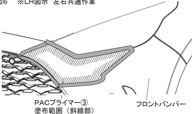
7. 図6のようにフロントバンパーガーニッシュ①の両面テープ貼付け部（左図斜線部）にPACプライマー③を塗布する。
