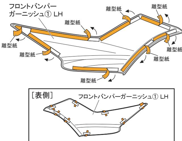
9. 図7のようにフロントバンパーガーニッシュ①の両面テープの離型紙を矢印の方向に約30mm剥がしてマスキングテープ等で表側に貼付ける。（左右各8箇所）
