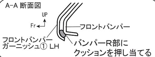
図4 ※LH図示 左右共通作業
