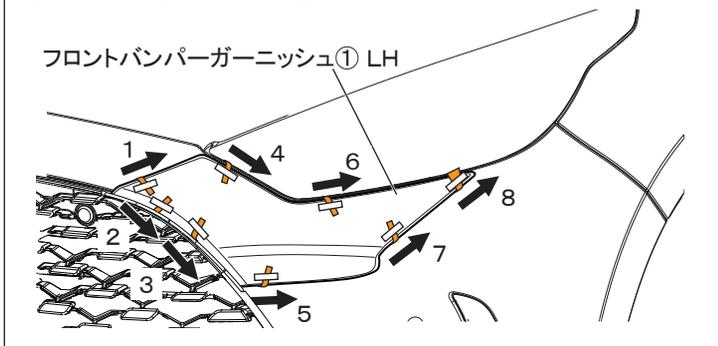
3. 図10のように取付け位置を確認して両面テープの離型紙を矢印の方向へ番号順に剥がしながら貼付け圧着する。(左右各8箇所)
