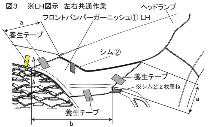
3. 図3のようにシム②をフロントバンパーガーニッシュ①とヘッドランプとの隙間に差し込み、シム②を二枚重ね図中の位置でフロントバンパーガーニッシュ①とフロントバンパーとの隙間に入れて取付け位置を一定隙 (a: 1mm、b: 2mm) にし、クッション部を突き当てながら、養生テープ等で仮固定する。
