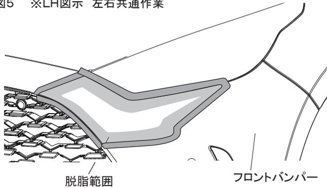
6. 図5のようにフロントバンパーガーニッシュ①の両面テープ貼付け部の汚れを取り除き、IPAで一方方向に拭いて脱脂する。
