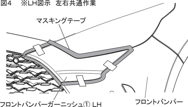
4. 図4のようにフロントバンパーガーニッシュ①の端末に合わせてフロントバンパーにマスキングテープを貼付ける。
