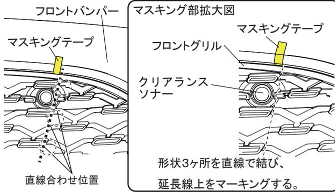
1. 図1のようにフロントグリル内のクリアランスソナー付近凸部形状3ヶ所を直線で結んだ延長線をマスキングテープ末端でフロントバンパーにマーキングする。
