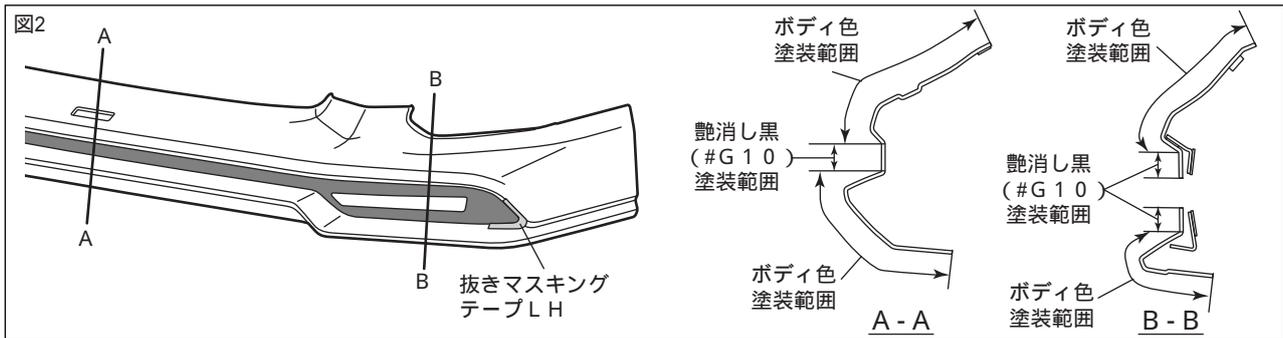
2. 図2のようにフロントスポイラー を抜きマスキングテープ を使用してマスキングし、艶消し黒(グロス10)相当で塗装する。
