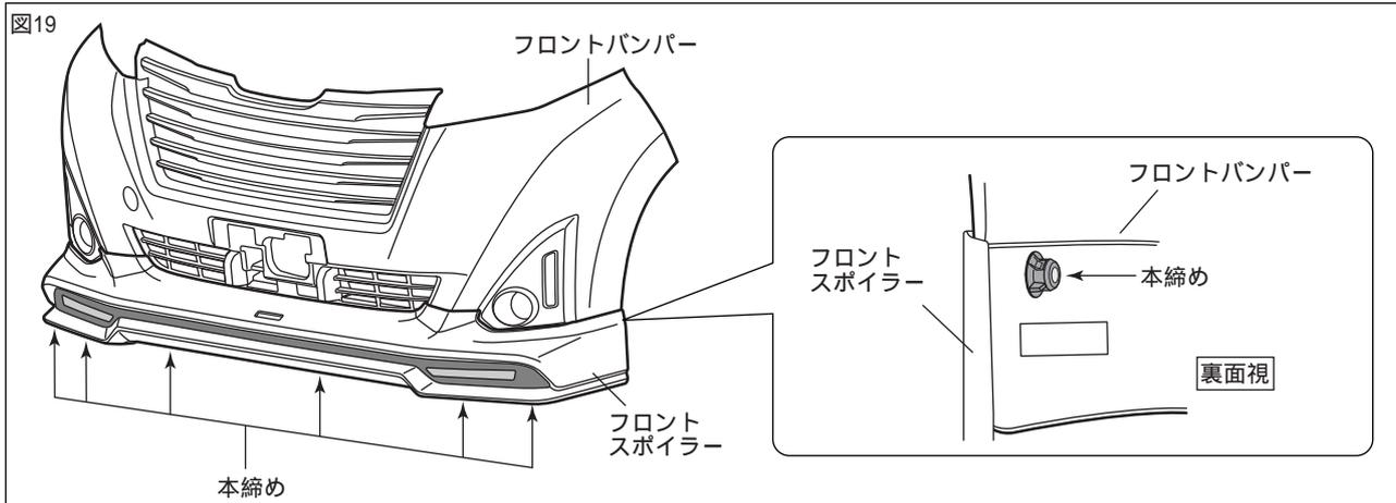
5. 図19のように仮締めしておいた下面の車両タッピングスクリュー(左右各2箇所)及びタッピングスクリュー(左右各1箇所)、クリップナット(左右各1箇所)を本締めする。
