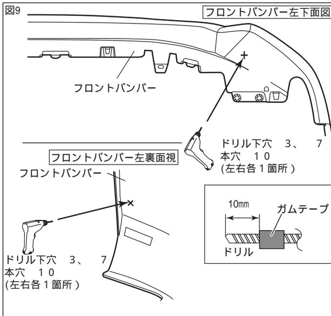
5. 図9のように 3、7、10のドリルの先端にストッパーになるようガムテープを巻きつけ、3、7のドリルを使用してマーキング位置に下穴をあける。
