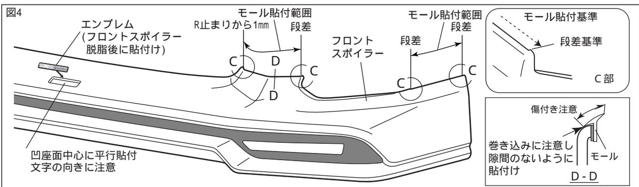
2. 図4のようにフロントスポイラー に、モールの離型紙を剥がしながら、貼付け確実に圧着する。
