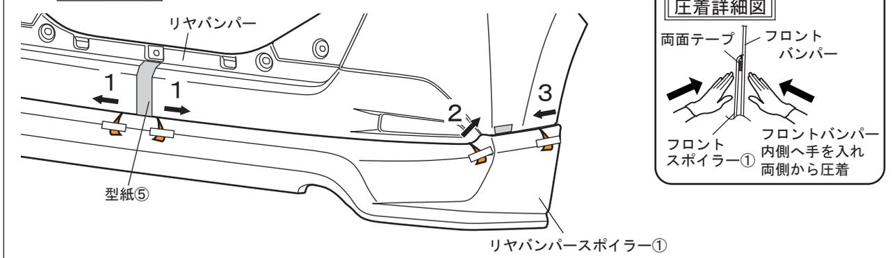
9. 図15を参考にリヤバンパースポイラー①の取付け高さ位置を型紙⑤とマスキングテープに合わせ、左右のズレ、隙が無いか確認し、両面テープの離型紙(左右各3箇所)を番号順に剥がしながら貼付け圧着する。
