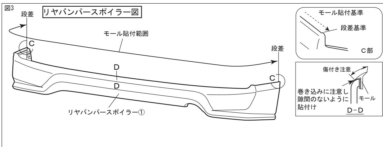
2. 図3のようにリヤバンパースポイラー①に、モール⑦の離型紙を剥がしながら、貼付け確実に圧着する。
