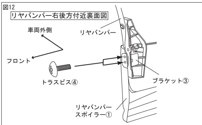
5. 図12のようにトラスビス④で仮締めをする。
