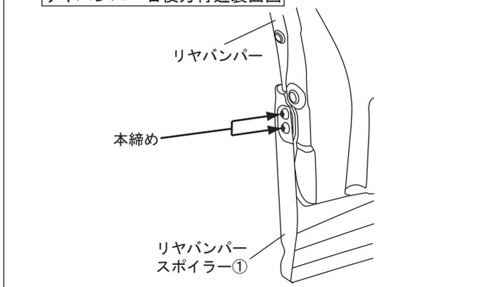
10. 図16のように仮固定しておいたトラスビス④を本締めをする。
