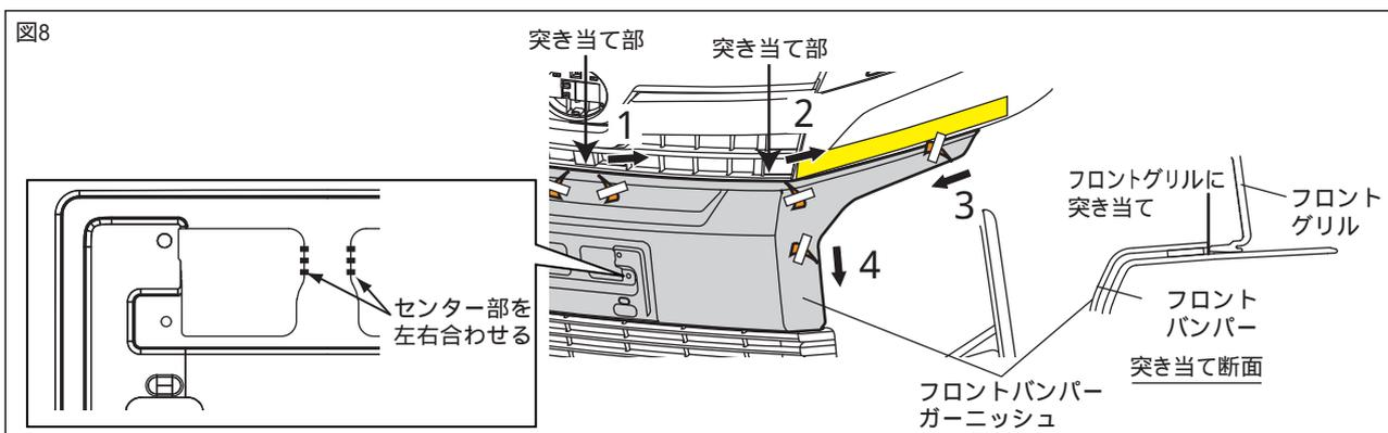
2. 図8のようにフロントバンパーガーニッシュとフロントバンパーとの左右のズレ、隙が無いか確認し、両面テープの離型紙(左右各4箇所)を番号順に剥がしながら貼付け圧着する。
