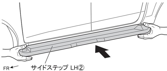
4. 図5のように車両サイドステップ LH②を取付けたブラケットに装着する。
