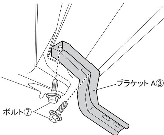
1. 図2のように車両フロント側の取付け部にブラケット A③をボルト⑦を使用して仮締めする。（左右各2箇所）
