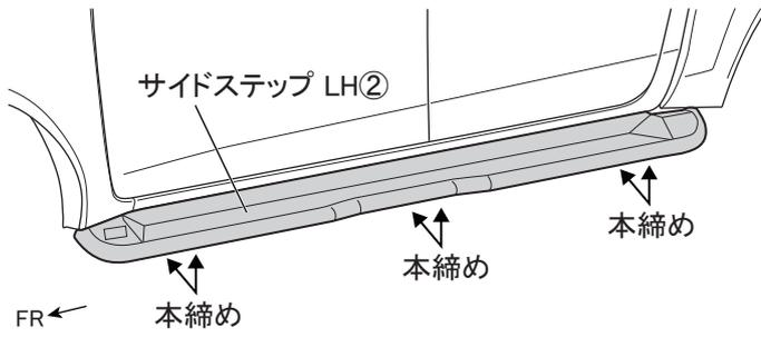
6. 図7のように前作業で仮締めしたサイドステップ及び、ブラケット取付け部の位置を確認して規定トルクで本締めする。
