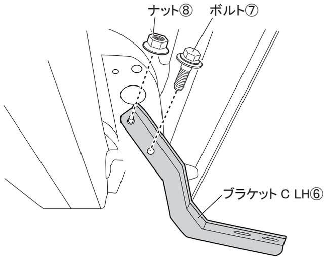
3. 図4のように車両リヤ側の取付け部にブラケット C LH⑥をボルト⑦、ナット⑧を使用して仮締めする。(左右各2箇所)
