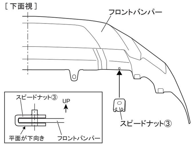
5. 図3のようにフロントバンパーのφ8.0穴に合わせスピードナット③を取付ける。(左右各1箇所)
