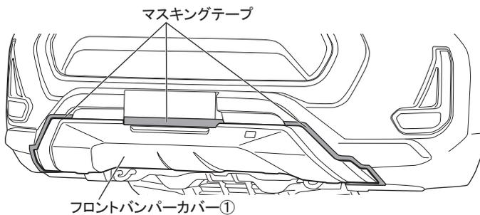
7. 図5のようにフロントバンパーカバー①上端（モール貼り付け部はモール上端）に合わせてフロントバンパーにマスキングテープを貼り付ける。
