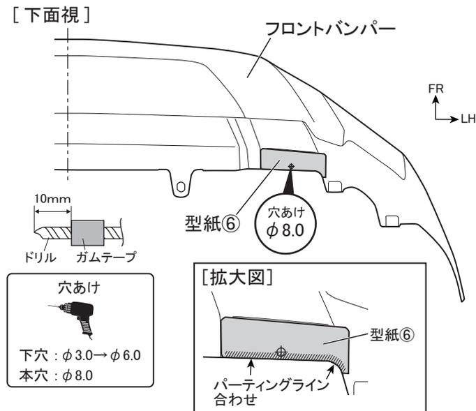
3. 図2のようにフロントバンパー下面に型紙⑥を貼り付け、穴あけ位置に合わせて下穴をφ3.0→φ6.0の順であけ、φ8.0の本穴をあける。(左右各1箇所)
