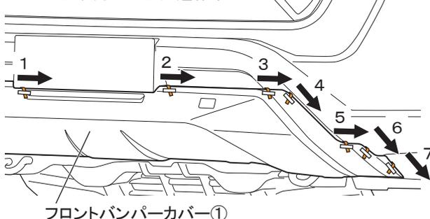
2. 図10のように取付け位置を確認して両面テープの離型紙を矢印の方向へ番号順に剥がしながら貼付け圧着する。（全13箇所）
