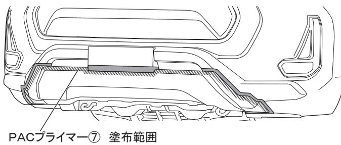
10. 図7のようにフロントバンパーカバー①の両面テープ貼付け部（左図斜線部）にPACプライマー⑦を塗布する。
