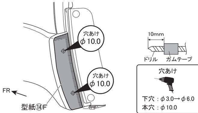
4. 図4のようにリヤホイールハウス折り返し部の型紙14Fの穴あけ位置に合わせて下穴をφ3.0→φ6.0の順であけ、φ10.0の本穴をあける。(左右各2箇所)
