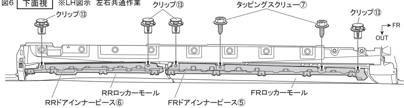
8. 図7のようにFRドインナーピース5、RRドインナーピース6側面の穴位置に合わせてFRロッカーモール、RRロッカーモール穴あけ位置をマーキングする。(左右各6箇所)
