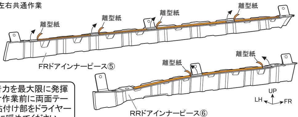
△注意：両面テープの接着力を最大限に発揮させる為、貼付け作業前に両面テープ部及び車両の貼付け部をドライヤー等で約40℃程度に暖めてください。
