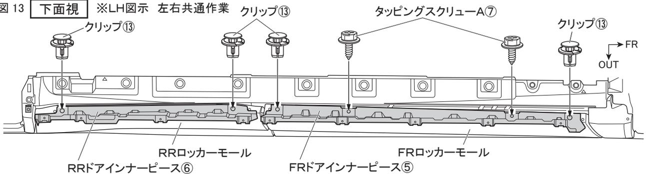
16. 図 14 のようにFRドインナーピース⑤、RRドインナーピース⑥側面の穴位置に合わせてタッピングスクリュー⑦を仮締めする。（左右各6箇所）
