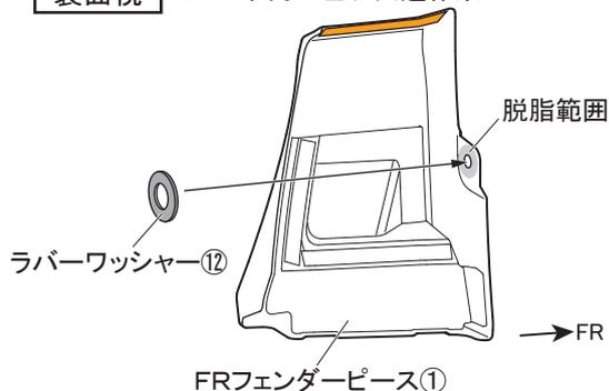
19. 図 17 のようにFRフェンダーピース①のホイールハウス部裏側の穴周囲の汚れを取り除き、IPA又はホワイトガソリンで一方向に拭いて脱脂し、ラバーワッシャー⑫を貼り付ける。(左右各1箇所)
