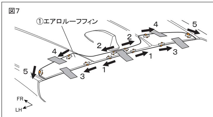
2. 図7のように取り付け位置を確認して両面テープの離型紙を矢印の方向へ番号順に剥がしながら貼り付け圧着する。(左右各5箇所)
