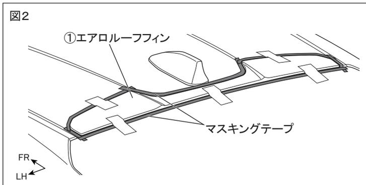
2. 図2のように①エアロルーフィングの末端に合わせてルーフパネルにマスキングテープを貼り付ける。
