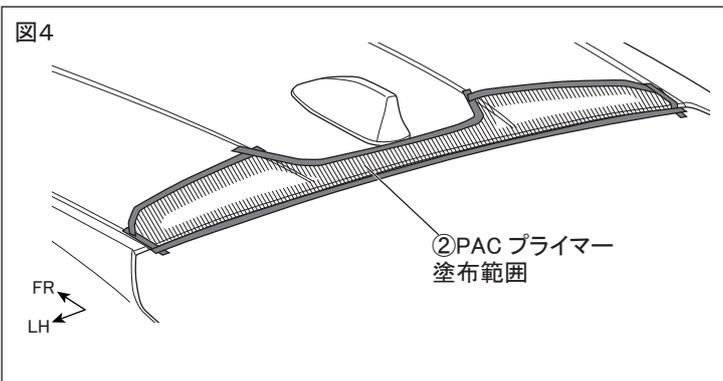
5. 図4のように①エアロルーフィンの両面テープ貼り付け部（左図斜線部）に②PACプライマーを塗布する。
