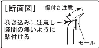
2. 図4のようにフロントスポイラー①にモール⑧⑨の両面テープの離型紙を剥がしながら、貼付け圧着する。モールは長めに設定されているので、長さを合わせてハサミ等で切り落とす。
