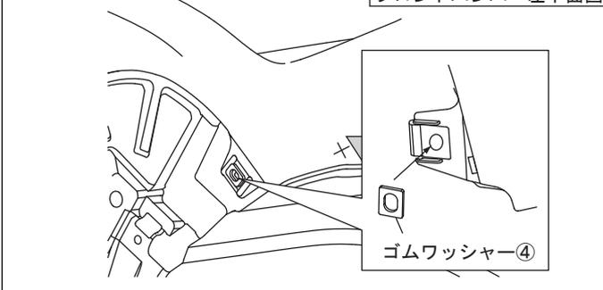
17. 図14のようにフロントバンパーホイールハウス部の下側にゴムワッシャー④を貼り付ける。(左右各1箇所)
