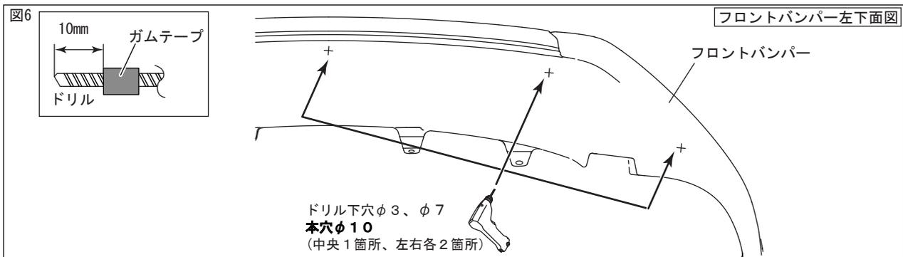
4. 図6のようにφ3、φ7、φ10のドリルの先端にストッパーになるようガムテープを巻きつけ、φ3、φ7のドリルを使用してマーキング位置に下穴をあける。
