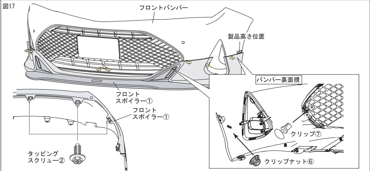
1. 図17のようにフロントバンパーにフロントスポイラー①をかぶせるて、フロントバンパー裏側のホイールハウス部のフロントスポイラー①をクリップナット⑥で仮締めをする。 (左右各1箇所)
