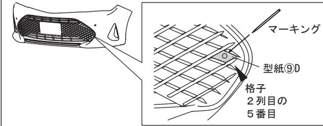
11. 型紙⑨Dを剥がし図10のようにフロントバンパーのグリルの格子に合わせて貼付け、マーキングする。(左右各1箇所)
