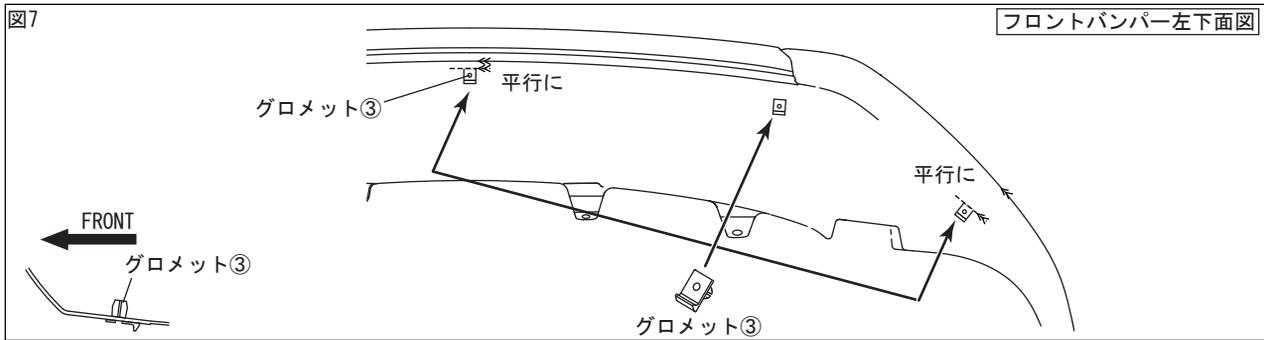
6. 図7のように前作業で穴あけ加工をした穴にグロメット③を差し込む。(中央1箇所、左右各2箇所)
