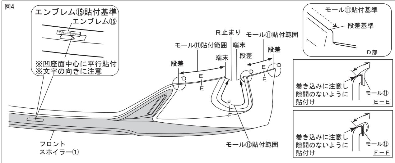
4. 図4のようにフロントスポイラー①に、モール⑪⑫の離型紙を剥がしながら、貼付け確実に圧着する。
