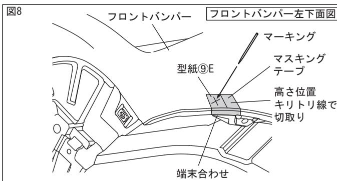
7. 型紙⑨Eを剥がし、図8のようにフロントバンパーのホイールハウス端末部に合わせて貼付け、マーキングする。
