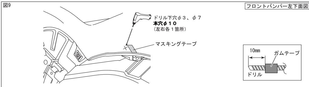
9. 図9のようにφ3、φ7、φ10のドリルの先端にストッパーになるようガムテープを巻きつけ、φ3、φ7のドリルを使用してマーキング位置に下穴をあける。
