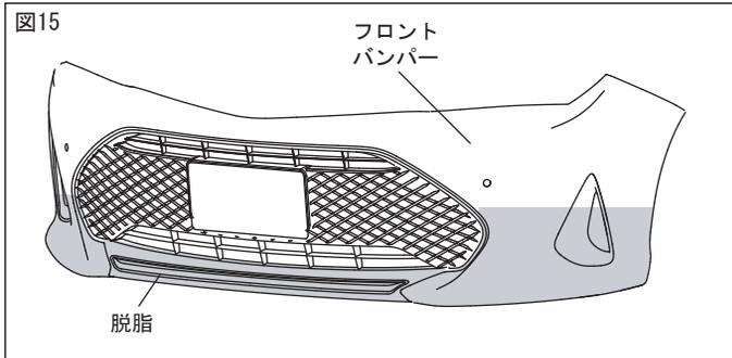
18. 図15のようにフロントスポイラー①取付部の汚れを取り除き、IPA又はホワイトガソリンで一方向にふいて脱脂する。
