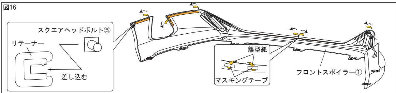
19. 図16の拡大図のようにフロントスポイラー①に付いているリテーナーに、スクエアヘッドボルト⑤を差し込む。
