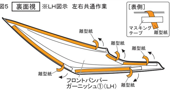
7. 図5のようにフロントバンパーガーニッシュ①の両面テープの離型紙を矢印の方向に約30mm剥がしてマスキングテープ等で表側に貼付ける。(左右各5箇所)
