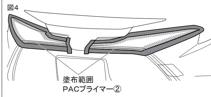
5. 図4のようにフロントバンパーガーニッシュ①の両面テープ貼付け部（左図斜線部）にPACプライマー②を塗布する。
