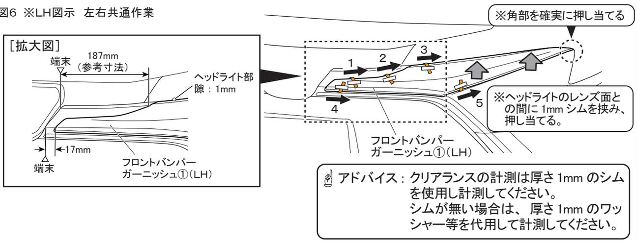
👉 **アドバイス** 両面テープの接着力は安定するまで3～5時間程度必要です。製品の取付け後は、最低3時間程度、強い振動や風圧（車両の移動を含む）が、掛からないようにオープンタイム（静止時間）お取りください。
