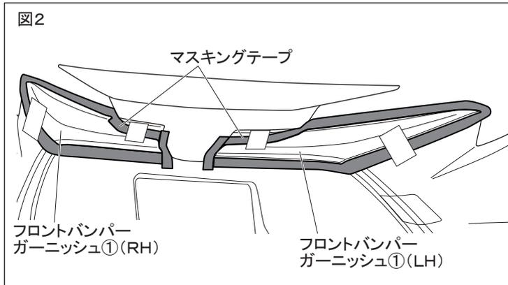
2. 図2のようにフロントバンパーガーニッシュ①の端末（モールド貼付け部はモール端末）に合わせてフロントバンパーにマスキングテープを貼付ける。
