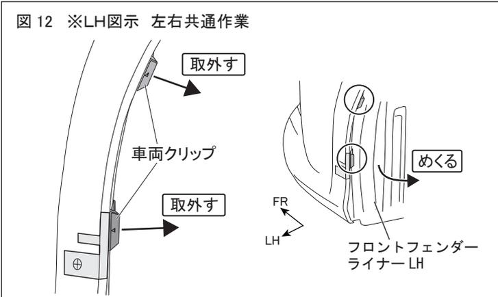
3. 図12のようにホイールハウス部の車両クリップを取外し(左右各2箇所)、フロントフェンダーライナーを一部めくる。
