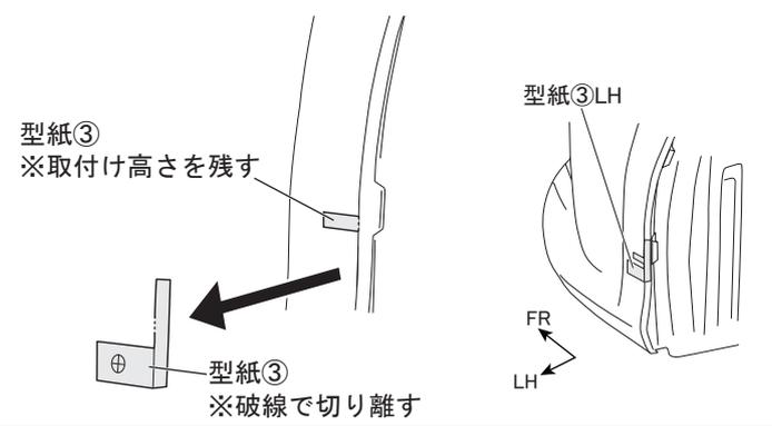
5. 図 14 のように型紙③のフロントスポイラー取付け高さ位置 (モール上端合わせ) を残し破線に沿って剥がし、加工穴周囲のバリを除去する。
