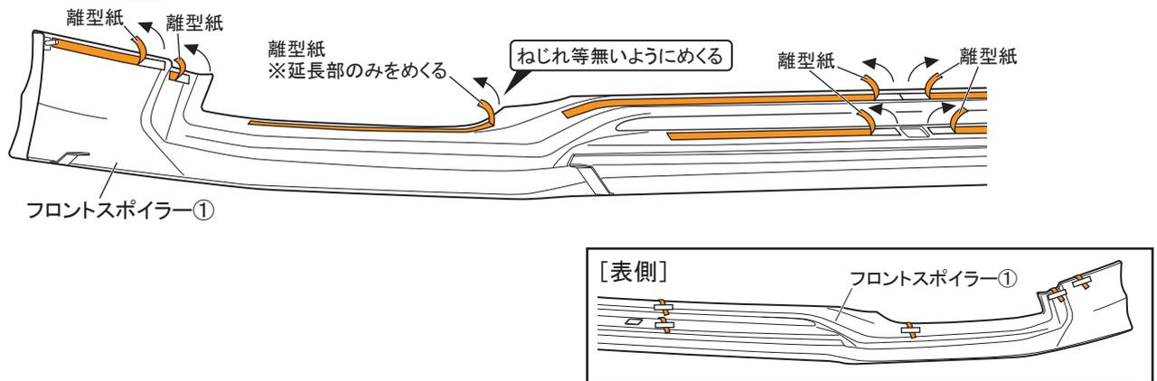
△注意：両面テープの接着力を最大限に発揮させる為、貼付け作業前に両面テープ部及び車両の貼付け部をドライヤー等で約40℃程度に暖めてください。
