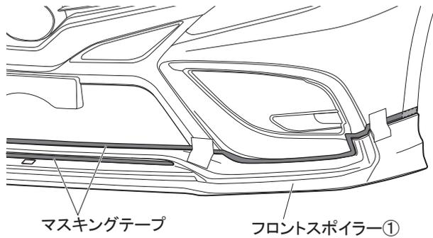
7. 図 16 のようにフロントスポイラー①上端（モール貼付け部はモール上端）に合わせてフロントバンパーにマスキングテープを貼付ける。
