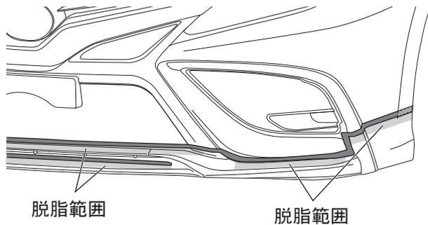
9. 図 17 のようにフロントスポイラー①の両面テープ貼付け部の汚れを取除き、IPA又はホワイトガソリンで一方方向に拭いて脱脂する。
