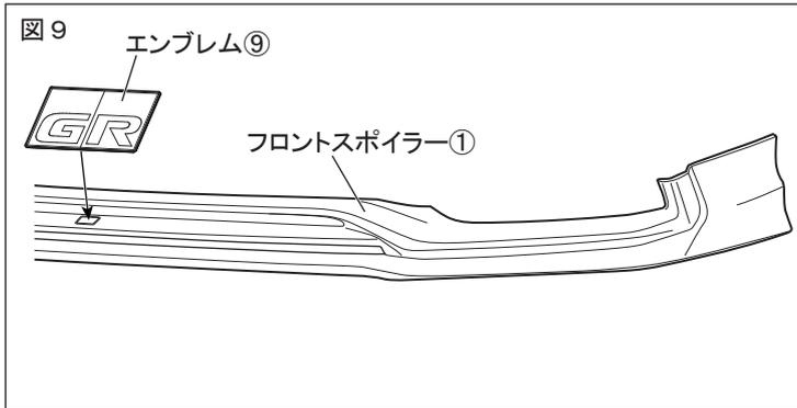
1. 図9のようにフロントスポイラー①中央の凹部の座面をIPA又はホワイトガソリンで一方方向に拭いて脱脂し、エンブレム⑨を貼付け圧着する。
