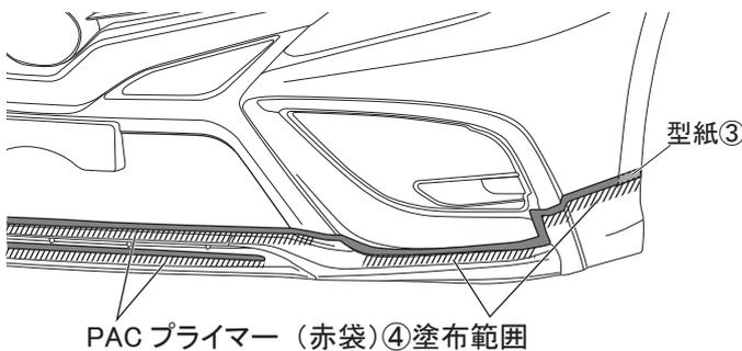
10. 図 18 のようにフロントスポイラー①の両面テープ貼付け部（左図斜線部）にPACプライマー（赤袋）④を塗布する。
