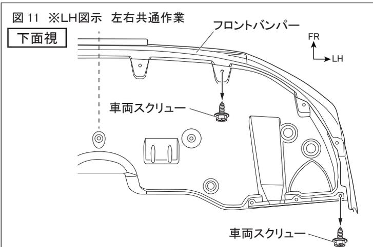
2. 図11のようにフロントバンパー下面の車両スクリューを取外す。(左右各4箇所)
