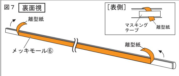
3. 図7のようにメッキモール⑥の両面テープの離型紙を矢印の方向に約30mm 剥がしてマスキングテープ等で表側に貼付ける。
