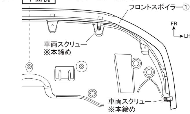
7. 図 23 のようにフロントスポイラー①下面の車両スクリューを本締めする。（左右各2箇所）
