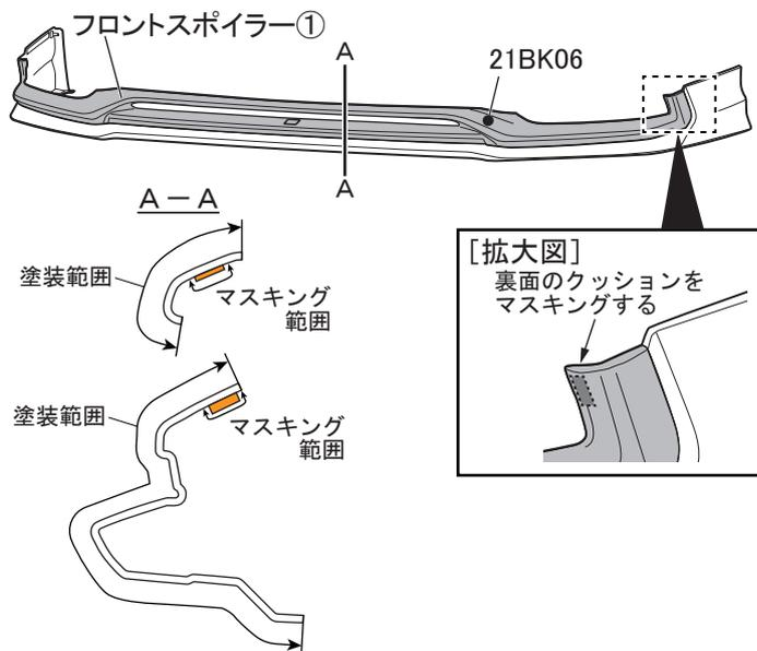
△注意：乾燥温度を70℃以上に上げますと製品に変形や割れが発生しますので乾燥温度には十分注意してください。強制乾燥させる場合は製品が変形しないように固定してください。
