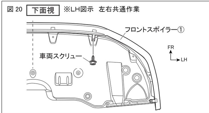
1. 図 20 のようにフロントスポイラー①下面を車両スクリューで仮締めする。(左右各1箇所)
