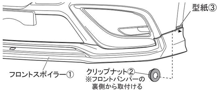
4. 図 22 のようにフロントバンパー裏側からフロントスポイラー①側面にクリップナット②を取付け、本締めする。（左右各1箇所）
