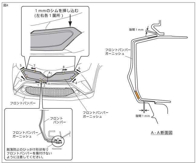
3.図4のようにフロントバンパーガーニッシュ が車両に平行で左右中心に来るように位置出ししながら、 フロントバンパーに合わせる。フロントバンパーガーニッシュ とフロントバンパーにズレが無いか確 認し、両面テープの離型紙(左右各3箇所)を番号順に剥がしながら貼付け圧着する。
