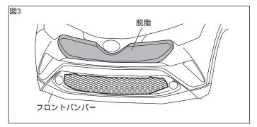
2.図3のようにフロントバンパーガーニッシュ 取付部の汚れを取り除き、PACクリーナ ー で一方向にふいて脱脂する。
