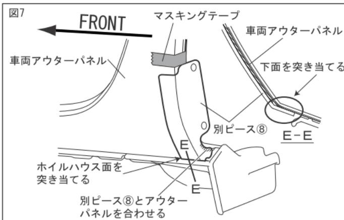
4. 図7のように別ピース⑧をリヤ側ホイールハウスの車両アウターパネルの形状に合わせて仮当てし、別ピース⑧の取付け高さ位置をマスキングテープでマーキングしてください。
