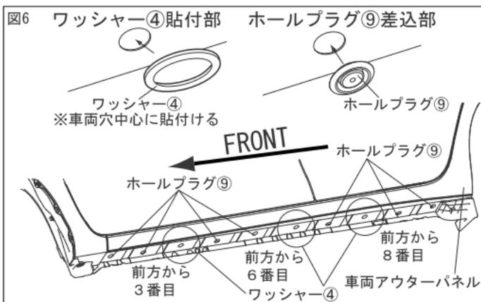
3. 図6のようにワッシャー④貼付部の汚れを取り除き、IPA又はホワイトガソリンで一方方向にふいて脱脂し、ワッシャー④(左右各3箇所)とホールプラグ⑨(左右各7箇所)を取付ける。
