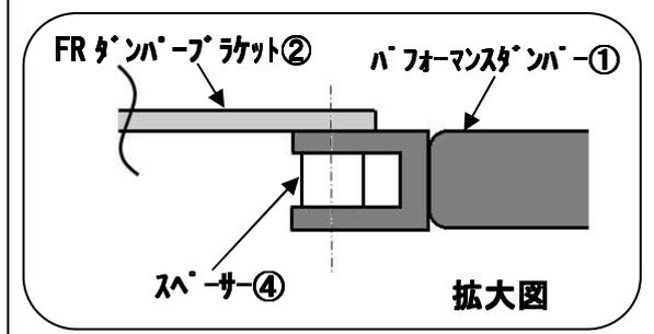
4. 図2のように、FRパフォーマンスダンパー①にFRダンパーブラケット②・スペーサー④をセットし、フランジボルト⑩・フランジナット⑪を使用して仮組みを行い、ASSY化する。
