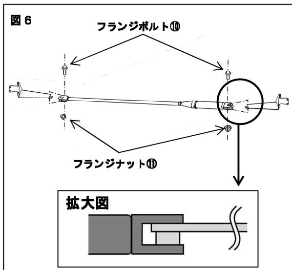
3. 図6のように、RRパフォーマンスダンパー⑤をフランジボルト・ナット⑩⑪で仮締めをする。
